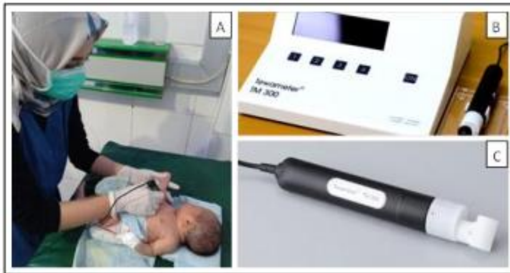
Gambar 1. (A) Pengukuran TEWL pada bagian volar lengan bawah. (B) Tewameter® TM300 Courage and Khazaka Electronic, Cologne, Germany. (C) Probe silindris yang tersusun atas 2 higrosensor untuk mengukur tingkat penguapan air pada kulit.
